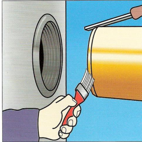
Chanfreiner chaque extrémité du tube à emboîter et lubrifier.
