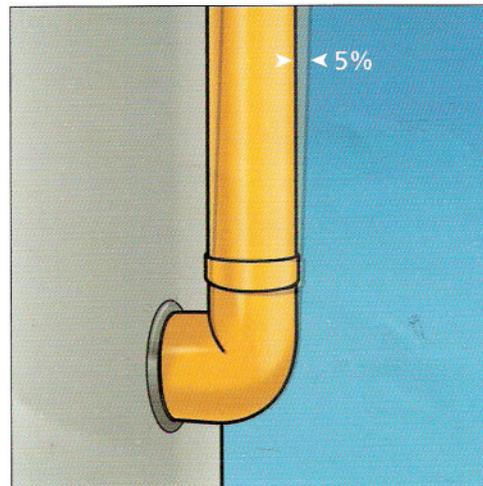
Le joint caoutchouc à triple lèvre permet des déviations angulaires de 5 %.
