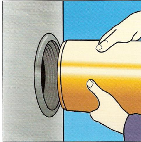
Centrer et assembler de manière à aligner l'extrémité du tube avec la paroi intérieure de l'élément en béton.
