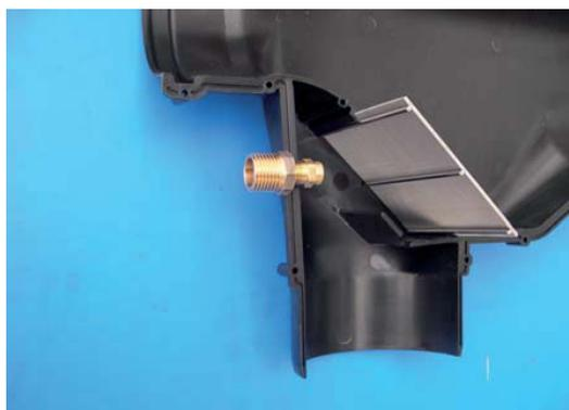
Il suffit pour chassant pendant 30 secondes eau propre à une pression minimum de 3 bar par une conduite de 1/2" une en l'arroseur avec conus plein. Ce nettoyage est manuellement possible en manière d'ouvrir un robinet ou automatique par une le robinet conduit avec l'horloge.
